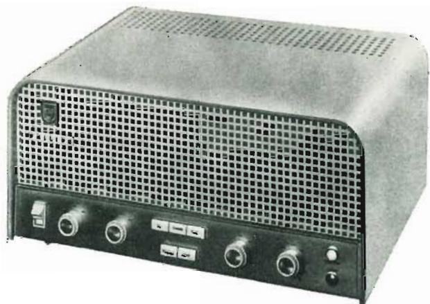
L'amplificatore stereo AG9014 consta di due amplificatori separati meccanicamente accoppiati. Ciascun amplificatore è formato da un preamplificatore a due valvole (EF86, ECC83) e da un amplificatore di potenza da 10 W a tre valvole (ECC83, 2 x EL86), in questo modo la potenza audio è di 20 W, disponibili per segnali stereo o monofonici. In questo ultimo caso le entrate dei due amplificatori di potenza sono disposte in parallelo all'uscita di un amplificatore, l'altro rimane inattivo.
